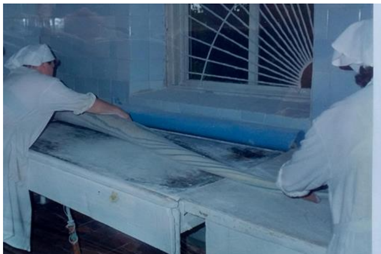
Растягивание карамельной массы на охлаждающем столе
