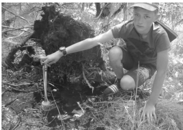
← Измерение температуры воды в лесном источнике во время краеведческой смены летнего палаточного лагеря «Страна Байкалия», июль 2019 г. Измерения температуры воды производились с помощью специального гидрологического термометра в металлической колбе и с пластмассовым стаканчиком на конце.
