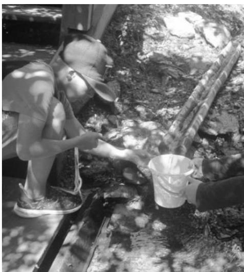
**Дебит родника** – количество воды (объем в литрах), вытекающее из родника за определенное время (секунды) **л/сек**. Струя воды из источника собирается в емкость известного объема, секундомером засекаем время наполнения этой емкости, далее количество воды, наполнившей вашу емкость в литрах делим на время наполнения в секундах и получаем дебит. Можно потренироваться дома, в школе, включив воду из крана. В среднем дебит воды из крана составляет 0,1 л/с.
